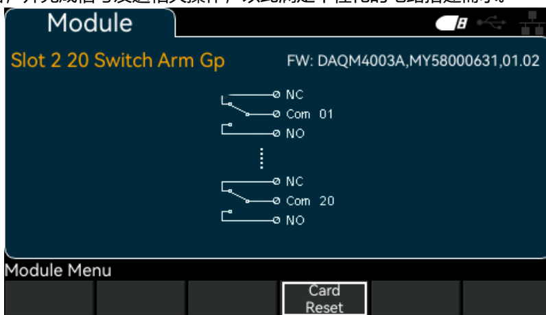
图 8.3 DAQM4003A 开关模块
