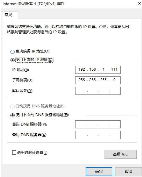
图 9.2 设置计算机以太网属性
