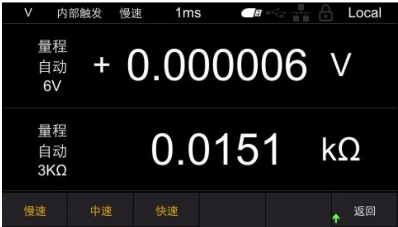
图 6.2 设置采样速率
