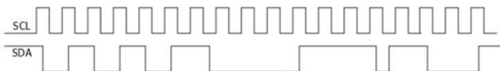
图 14.4 I2C 串行总线示意图
