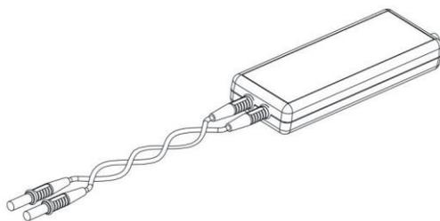
2) 在测量时尽量不要延长输入线，否则会引入更多的噪声。如必须额外加长输入线，则应保证延长线的长度相同。而且，此时测量输入的信号频率应不超过 10MHz，如果测量信号频率超过 10MHz，误差将会较大。
