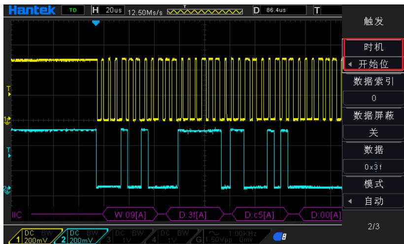
**IIC 触发设置 2:** SCL: CH1; SDA: CH2; 时机: 地址和数据; 地址: 09; 数据: 3f xx xx xx (索引 0 的数据屏蔽“关”，索引 1、2、3 的数据屏蔽“开”)。触发显示如下:
