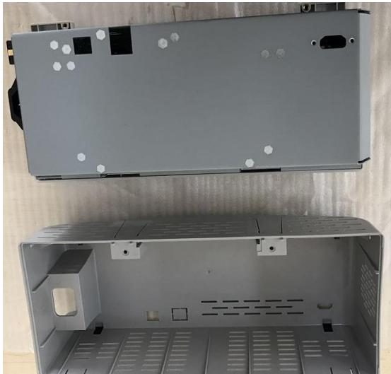
2. 卸下后钣金上的所有螺钉，取下后钣金。
