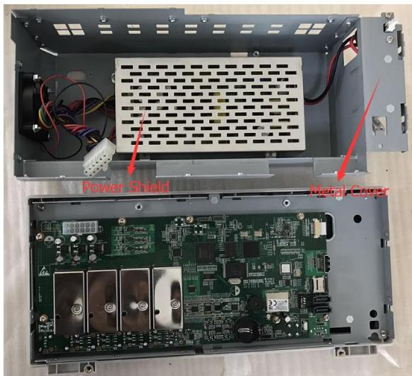
3. 卸下电源屏蔽罩上的所有螺钉，取下屏蔽罩。便可以看见电源板上的保险丝。用相同规格的新保险丝进行更换。
