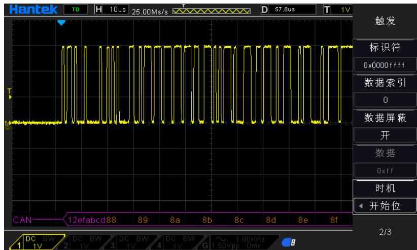
**Can 触发设置 2:** 信源: CH1; 波特率: 1000000; 空闲电平: 低; 时机: 数据帧 ID; 标识符: 12efabcd。触发显示如下:
