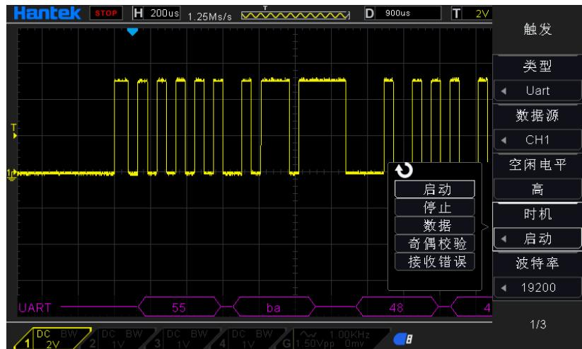
**UART 触发设置 2:** 信源: CH1; 空闲电平: 高; 波特率: 19200; 奇偶校验: 无; 数据位数: 8; 时机: 停止
