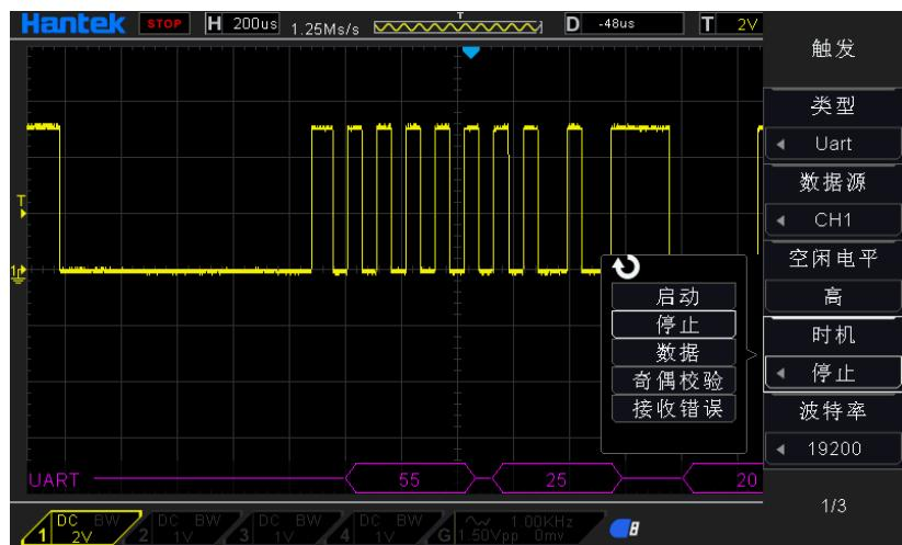
**UART 触发设置 3:** 信源: CH1; 空闲电平: 高; 波特率: 19200; 奇偶校验: 无; 数据位数: 8; 数据: 0x55; 时机: 数据; 条件: 等于(=)
