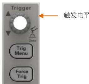
**触发释抑：**按下【Trig Menu】按钮，打开触发目录，按下**迟滞**软键。触发释抑功能可用来生成稳定的复杂波形（如脉冲列）显示。“释抑”是指示波器在检测某个触发和准备检测另一个触发之间的时差。在释抑期间，示波器不会触发。对于一个脉冲列，可以调整释抑时间，以使示波器仅在该列的第一个脉冲触发。
