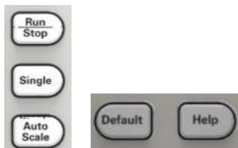
**Auto Scale:** 自动设置示波器控件，生成输入信号的有用显示。有关内容参见下表。
