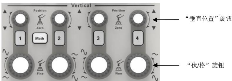
1. “垂直位置”旋钮：旋转该旋钮在屏幕上上下移动通道波形，在双窗口模式中同时控制两个窗口波形的移动，两个窗口的波形移动方向相同，且按照一定的比例关系。按下该旋钮波形回到屏幕垂直位置中间。两个通道分别对应两个旋钮。
